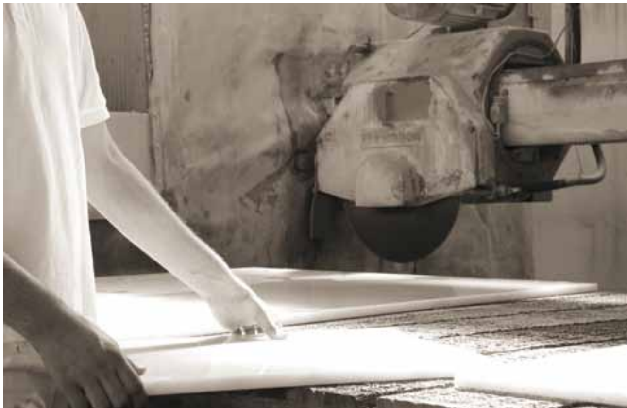
Milling Cutters. Metal discs with diamond plaques are used to cut and profile slabs. Le frese. Dischi metallic, dotati di placchette diamantate, vengono utilizzati per tagliare e rifilare le diverse lastre.
