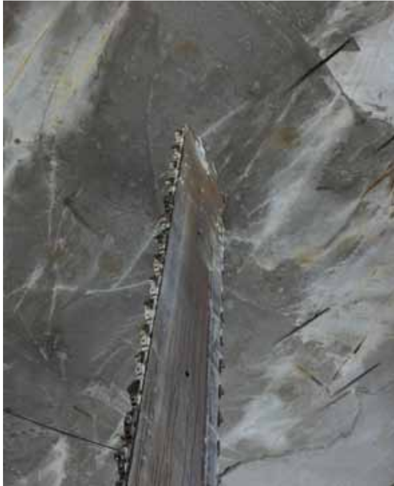
With the bridge cutting machine, horizontal and vertical cuts can be made with any inclination. Con le tagliatrici a catena si possono eseguire tagli orizzontali e verticali su qualsiasi tipo di materiale e con qualsiasi inclinazione.
