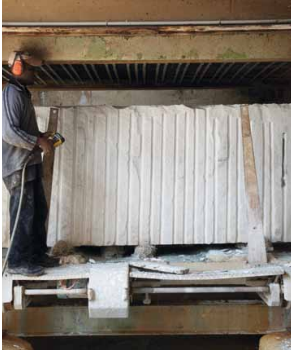
The gang saw process cuts blocks into slabs. Il processo di segagione a telaio riduce i blocchi in una serie di lastre.
